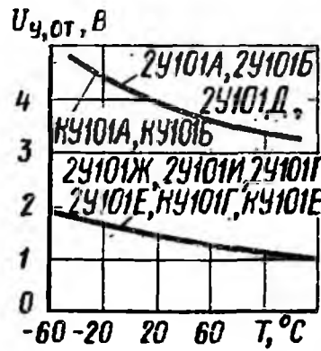
Зависимости отпирающего постоянного напряжения управления от температуры
