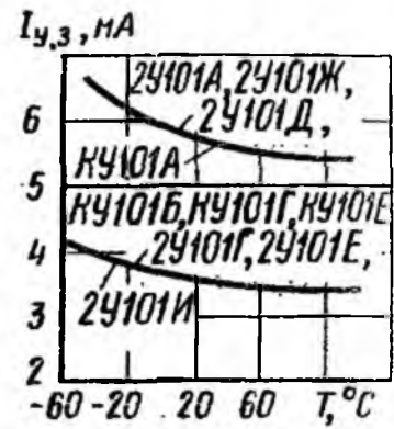
Зависимости отпирающего постоянного тока управления от температуры
